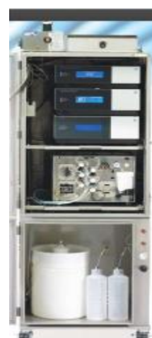
Рис.10.2 Расположение хроматографа Ultimate 3000 в защитном кожухе системы "Integral".
